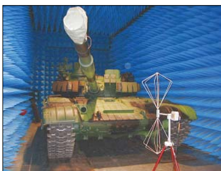
Zkouška tanku podle ČOS 599902 (MIL-STD-461E)
