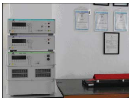
Část pracoviště pro provádění zkoušek elektromagnetické kompatibility na elektrických a elektronických komponentech motorových vozidel
