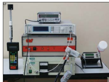
Pracoviště pro provádění zkoušek odolnosti proti vf elektromagnetickému poli
