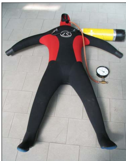
Zkouška těsnosti suchého potápěčského obleku
