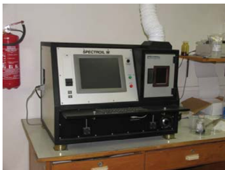
Atomový emisní spektrometr s rotační diskovou elektrodou SPECTROIL M pro AES/RDE spektroskopii
