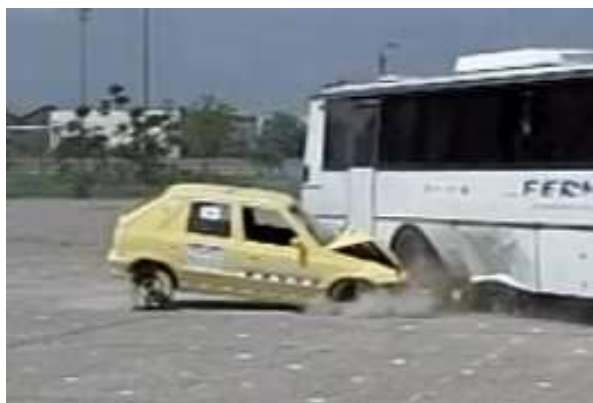
Obr. 5 Kontakt medzi pravým diskom kolesa a vozovkou (vzniká oblak prachu)
