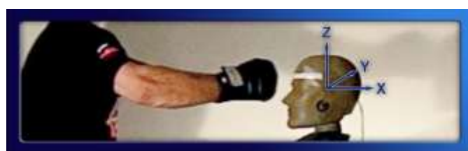
Obr.3 Umístění akcelerometru a jeho os
