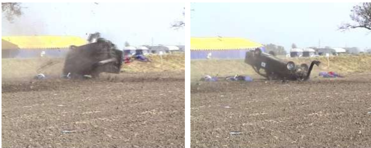
Obr. 8 Pohyb vozidla a figuríny počas testu
