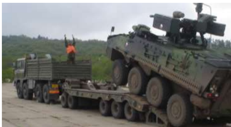
Obr. 3 Najetí na podvalník jízdou vpřed
