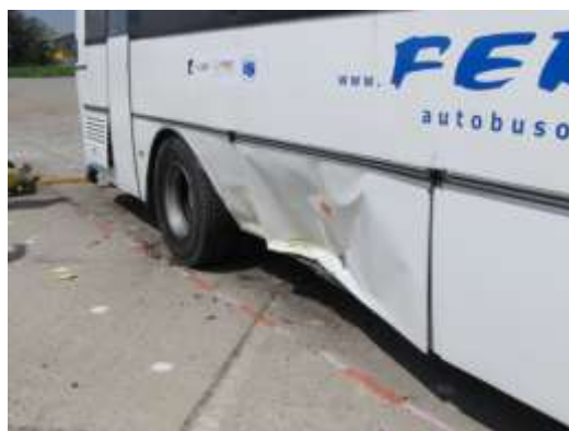
Obr. 3 Detail poškodenia autobusu pri teste č. 1
