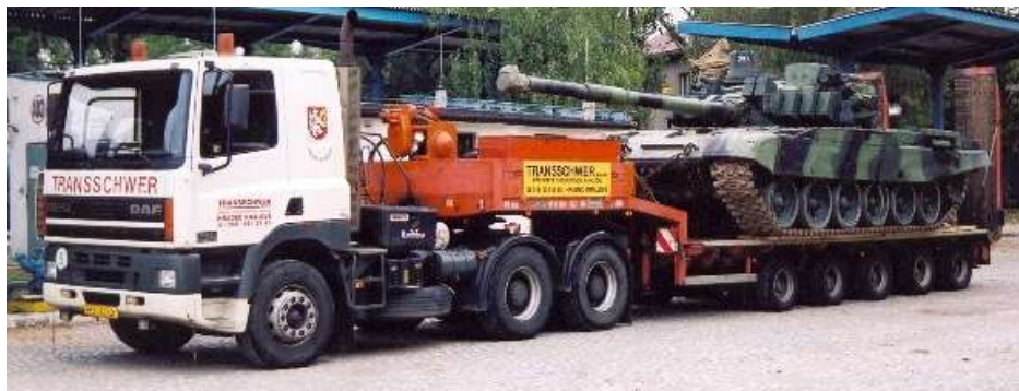
Obr. 4 Speciální návěs pro přepravu těžké techniky
